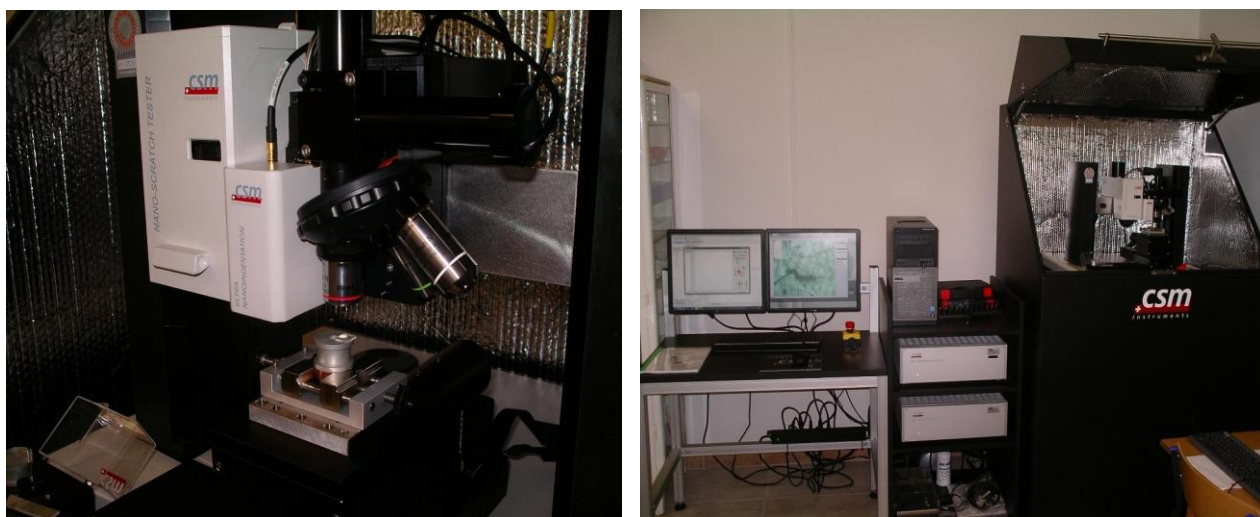
Рис. 2.6. Зображення установки ультрананоіндентування (UNHT) з програмним забезпеченням CSM Instruments, яка використовувалася для дослідження впливу неоднорідності полімерної матриці на механічні властивості затверділого полімеру у межах співпраці з Відділом прикладної фізики Люблінського технічного університету (м. Люблін, Польща).
