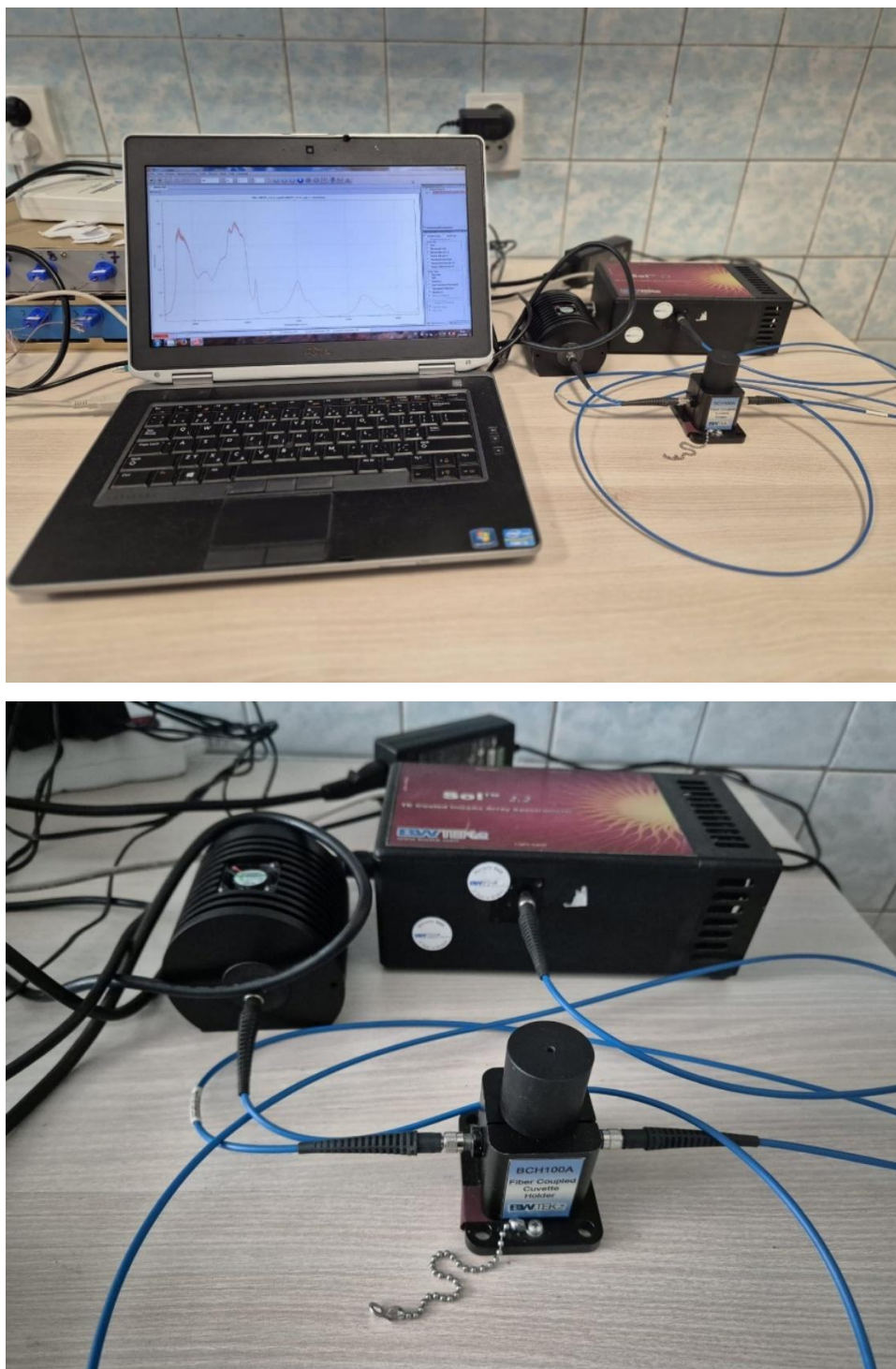
Рис. 2.5. Зображення БІЧ установки, яка використовувалася для реєстрації БІЧ спектрів у межах співпраці з Відділом синтезу та характеристики полімерів, Лабораторія електронного парамагнітного резонансу (ЕПР), Інституту полімерів Словацької академії наук (м. Братислава, Словаччина).
