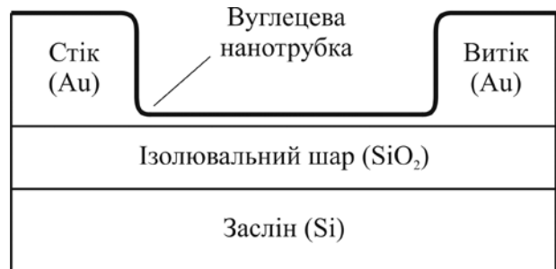
Рис. 3.21. Схема польового транзистора на основі вуглецевої нанотрубки
